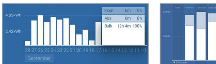
Links: Beispiel für ein System, das sich die ganze Zeit in der Konstantstromphase befindet. Rechts: Aufschlüsselung der Ladestufen - Das System verbringt Zeit in der Konstantstromphase und in der Konstantspannungsphase.
