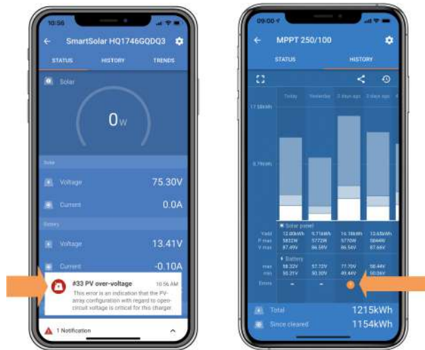
Ein aktiver Fehler und ein historischer Fehler.
