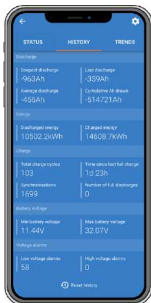
Verlaufsanzeige des Batteriemonitors in der VictronConnect App.
