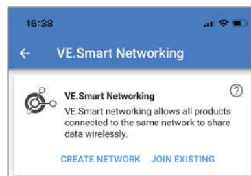
Erstellung eines VE.Smart-Netzwerks mit der VictronConnect App.
