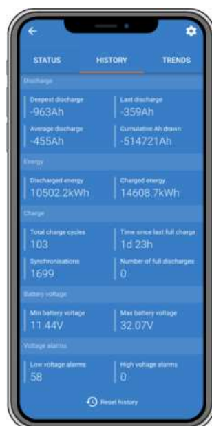
Verlaufsanzeige des Batteriemonitors in der VictronConnect App.
