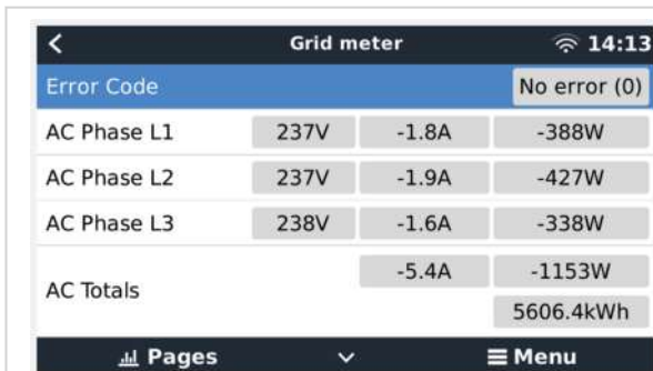
Detaillierte Übersichtsseite eines dreiphasigen Netzzählers
